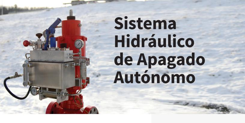
Nuestro sistema de seguridad hidráulico de apagado autónomo está diseñado específicamente para ubicaciones remotas donde las fuentes de energía externas no están disponibles, son poco confiables o costosas.
