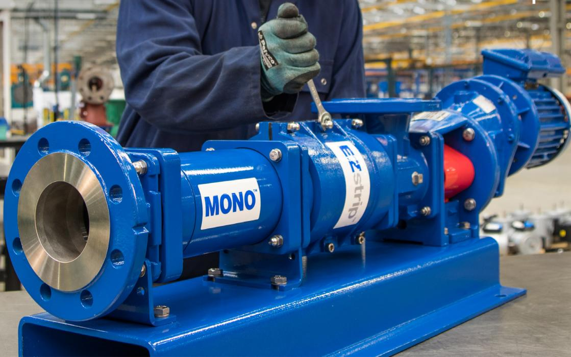
Die patentierte geteilte Kuppelstange ermöglicht eine einfache und leichte Wartung einer Exzentrerschneckenpumpe im eingebauten Zustand.
