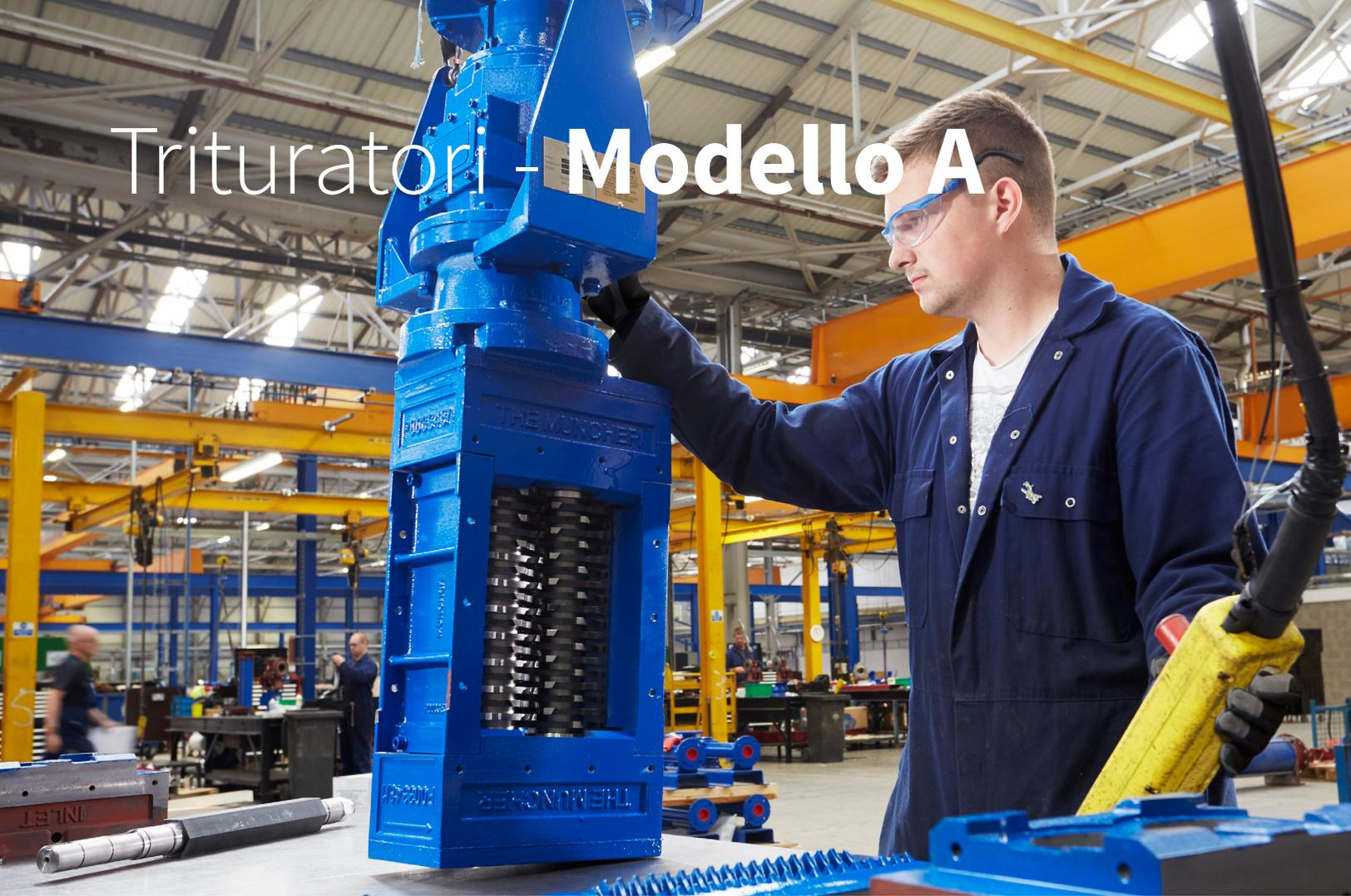
Trituratori con coppia elevata e bassa velocità di rotazione, per installazione in canale aperto o in pozzetto, progettati per disintegrare i solidi trascinati da un liquido.
