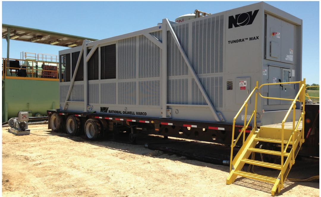
Una novedosa tecnología de enfriamiento de lodo en plataformas de perforación terrestres permite hoy gradientes de temperatura de fondo mucho más bajos y seguros, que conducen a un uso seguro y mejorado de las herramientas dinámicas de fondo necesarias para automatizar por completo el proceso de perforación.
