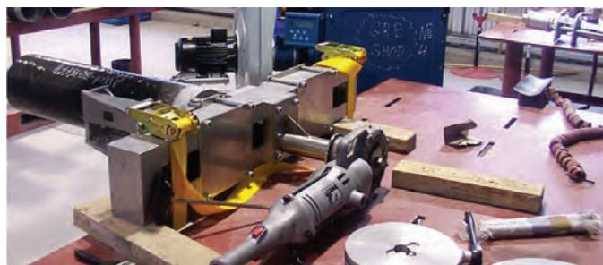
刮削管塞的刮管器
