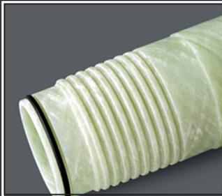
**斯达超级密封(SSS)**是一种安装快捷、工作可靠、能自锁的机械O型圈密封的全天候接头。对于最高温度为200°F (93.3°C)的一般工程，所用的O型圈是标准的丁腈橡胶圈。规格为2"~6" (50 mm ~ 150 mm)的斯达超级密封螺纹，用的是经过改进的高质量的每英寸4扣的自锁螺纹，而规格为8"~12" (200 mm ~ 300 mm)的斯达超级密封螺纹，用的是每英寸2扣螺纹。斯达高压超级密封螺纹用的是每英寸3扣螺纹，使得管道系统上扣的速度提高25%，压力可达到2500 psi (17.2 MPa)。
