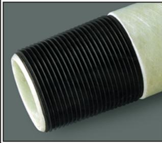
**先进复合材料螺纹(ACT)**是用含有树脂、石墨和陶瓷粉的一种特殊复合材料制成的优质螺纹接头。这种螺纹与特氟隆基螺纹脂或推荐的密封剂配合使用，再加上ACT螺纹公差严格的一致性，对输送高压液气流具有突出的密封性能和优异的上/卸扣性能。模制的ACT螺纹抗剪切强度高，耐化学腐蚀性能优异，同切削的或磨削的玻璃钢螺纹相比，优先选择ACT螺纹接头系统用于连接井下油管。ACT接头是按工业标准API 5B 10扣、8扣外加加厚长螺纹，以及OD 8扣螺纹生产的。公司提供的带ACT螺纹的井下油管主要是整体接头的，也有带接箍接头的。
