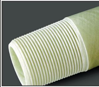
**精密磨削螺纹(PGT)**是用数控磨削机床加工而成的。由于PGT螺纹公差精密，上扣时只能用特氟隆基螺纹脂或推荐的密封剂。最常用的切削或磨削的玻璃钢螺纹需要缠特氟隆带，并涂特氟隆基螺纹脂，相比之下PGT螺纹则是一种改进。PGT接头是按工业标准8扣外加加厚长螺纹或OD 8扣螺纹生产的。PGT螺纹应用于管线管产品，为整体接头。
