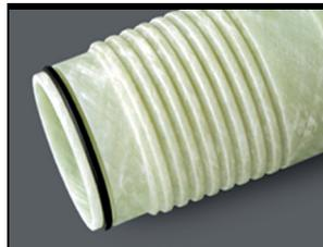
**STAR Super Seal (SSS)** es un aro tórico mecánico de autosujeción que sella en forma rápida y confiable bajo todo tipo de clima. Los aros tóricos son de nitrilo estándar para aplicaciones normales de hasta 200 °F (93,3 °C). La tubería se proporciona en tamaños de 8 a 12 pulgadas (200-300 mm) con dos roscas por pulgada.
