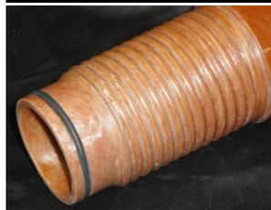
**Centron SP/SPH** es un patrón de 4 roscas por pulgada, además de ser una rosca sellada, también incorpora un sello de aro tórico autocontenido restringido para una mayor confiabilidad. Esta conexión excepcionalmente fácil de usar se utiliza en aplicaciones de alta presión de hasta 3500 psi (24,1 MPa) y 210 °F (99 °C).
