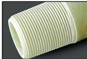
**Precision Ground Thread (PGT)** La rosca de esmerilado preciso se fabrica con equipo de esmerilado controlado numéricamente y las tolerancias obtenidas requieren solamente el uso de un lubricante a base de Teflón o un sellador patentado para el acoplamiento. La conexión PGT se fabrica de conformidad con los estándares de la industria con roscas EUE 8rd u OD 8rd.
