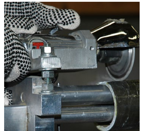
Cortadora de chaqueta: corta chaqueta de contención de tuberías LCX de 2 plg y 4 plg.
