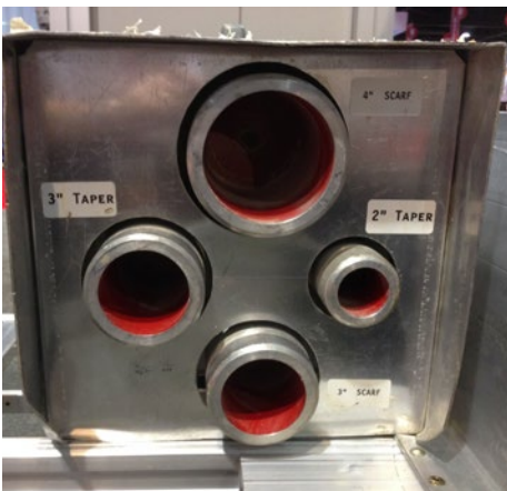
Herramienta modelo 2100: biseladores de tubería Red Thread IIA de 2 plg y 3 plg, bisel de tubería de 3 plg y 4 plg. Los mandriles para biselado están disponibles para los productos Dualoy.
