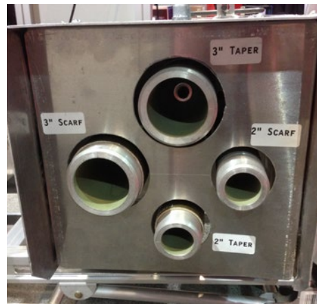
Herramienta modelo 3000: biselador y bisel para tubería LCX de 2 plg y 3 plg.
