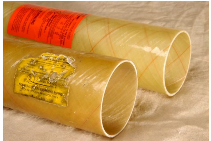
Anterior frente a nueva: la tubería en primer plano fue instalada en 1973 y retirada 27 años después cuando la estación cerró.
