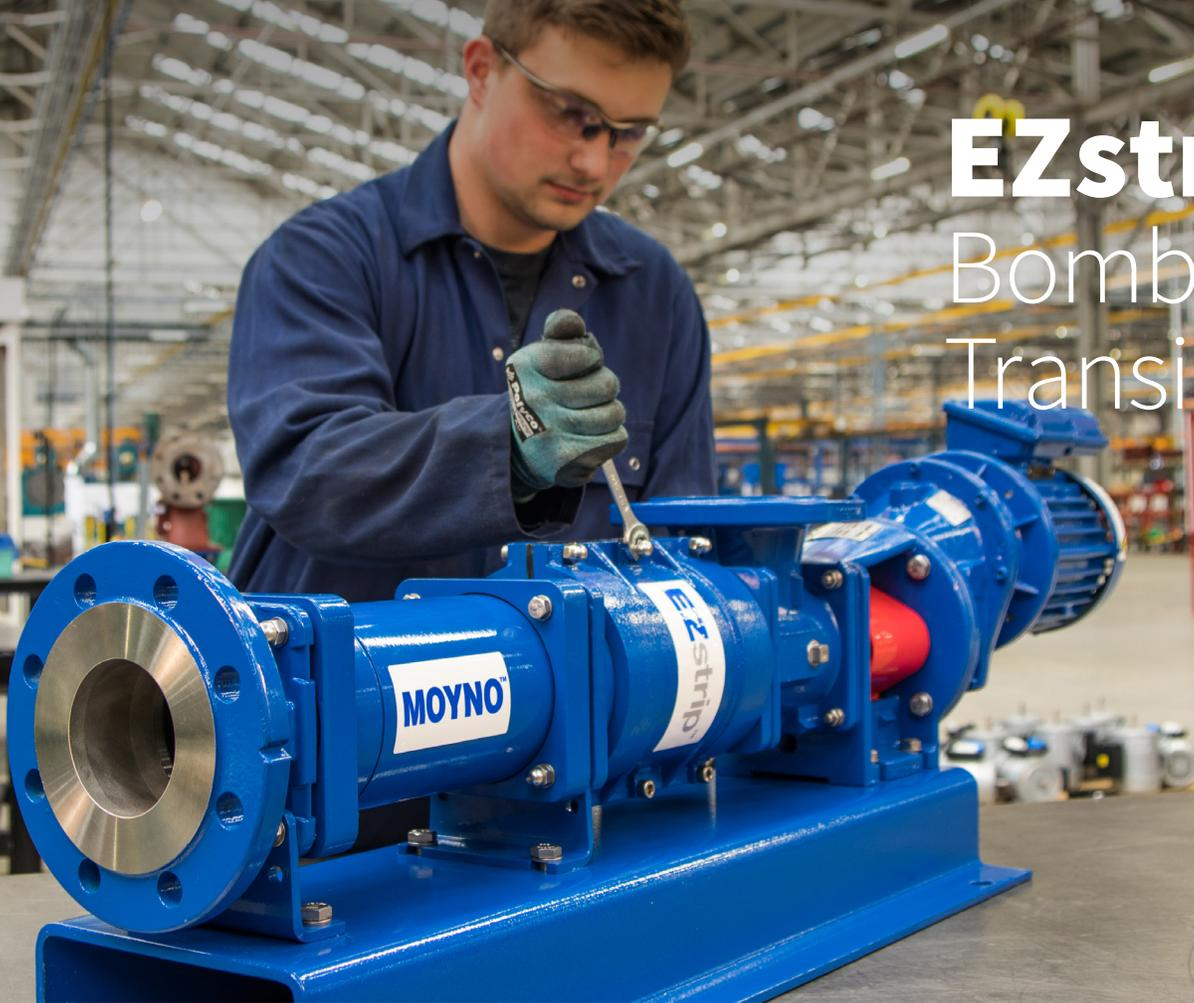
El sistema patentado de biela partida proporciona una forma rápida y fácil de desmontar y realizar el mantenimiento in situ, sin necesidad de desmontar la bomba de la instalación.
