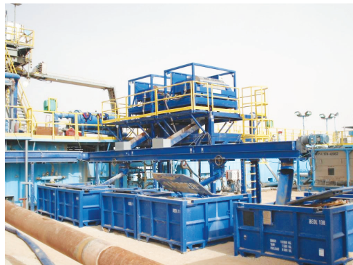
El sistema de desorción por alta temperatura y de control de sólidos de circuito cerrado de FluidControl utilizados en el Norte de África.
