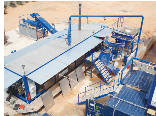
El sistema de desorción por alta temperatura y de control de sólidos de circuito cerrado de FluidControl utilizados en el Norte de África.
