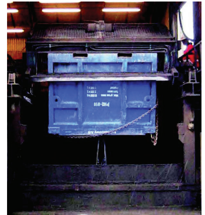
振动确保钻屑从吊斗上完全排放
