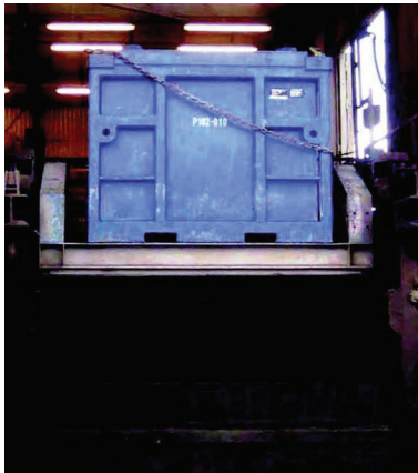
钻屑吊斗固定在转盘上
