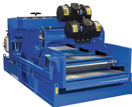
KING COBRA HYBRID Peneira Vibratória com CONSTANT-G CONTROL
