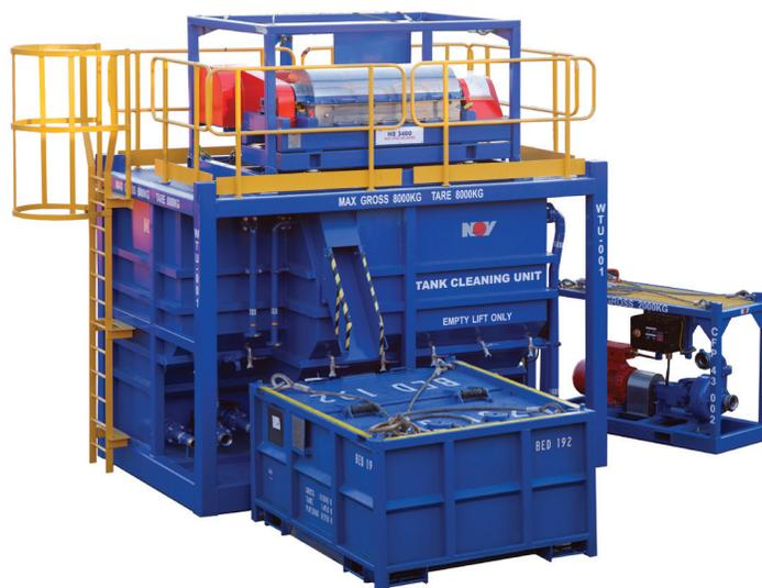
Le système de nettoyage de réservoir FluidControl a été conçu spécialement dans le but de réduire l'entrée de personnel dans les réservoirs ainsi que pour réduire au minimum la quantité d'eaux usées produites.
